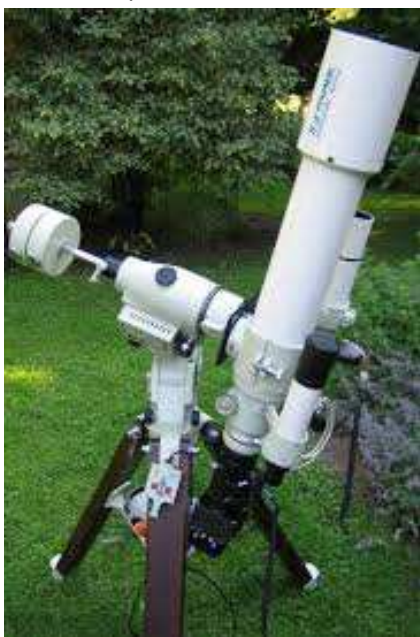
Fig1. Une monture allemande : la lunette va se bloquer contre le pied, il faut opérer un retournement de la monture !
